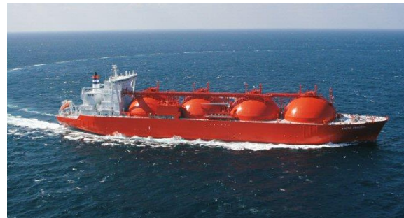
LNG carrier Arctic Princess with 147 000 m³ capacity [HÖEGH LNG, 2013]
