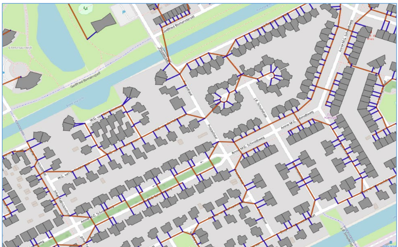
FIGUUR 5.9 – VOORBEELDRESULTAAT GREENVIS LEIDINGNET MODEL. ROOD GEEFT DE DISTRIBUTIELEIDINGEN. BLAUW GEEFT DE AANSLUITLEIDINGEN.
