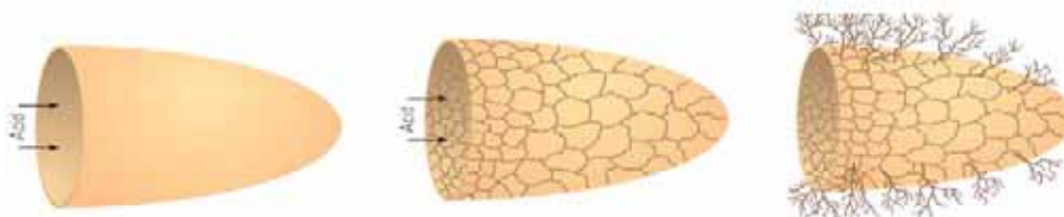
Figuur 3.1 Overzicht van chemische stimulatie met zuur. Van links naar rechts; zuur wordt in de scheur gepompt, de scheuren worden geëetst en het zuur creëert wormholes (Al-Anzi et al., 2003).
